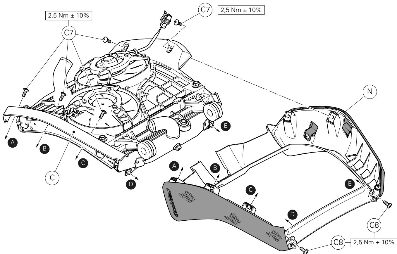
Posizionare il radiatore acqua (C) sull'assieme supporto radiatore (N) e fissarlo impuntando le n.5 viti originali (C7) e le n.2 viti originali (C8) nelle posizioni indicate.
