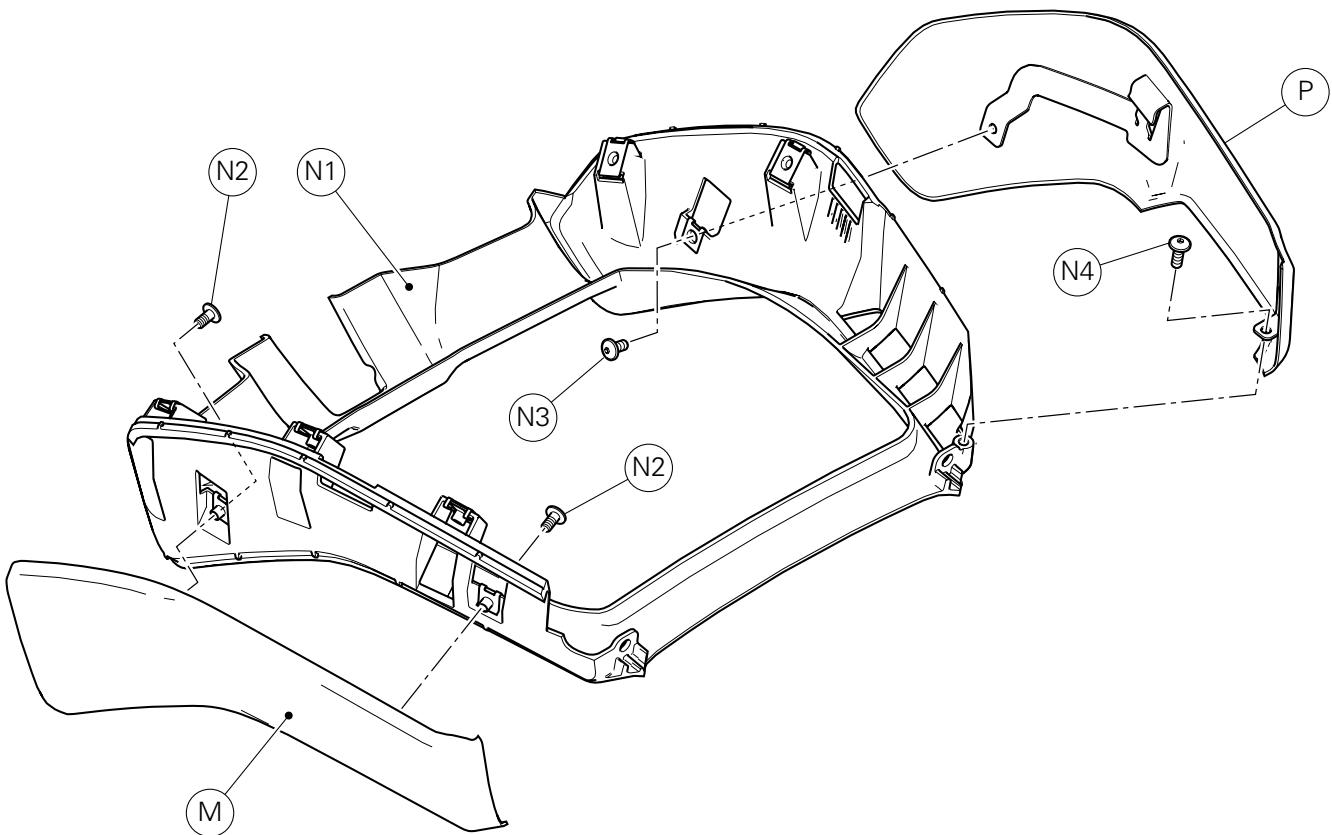
Operando sul lato sinistro del telaio supporto radiatore (N1), svitare le n.2 viti (N2) e rimuovere la cover sinistra (M).
