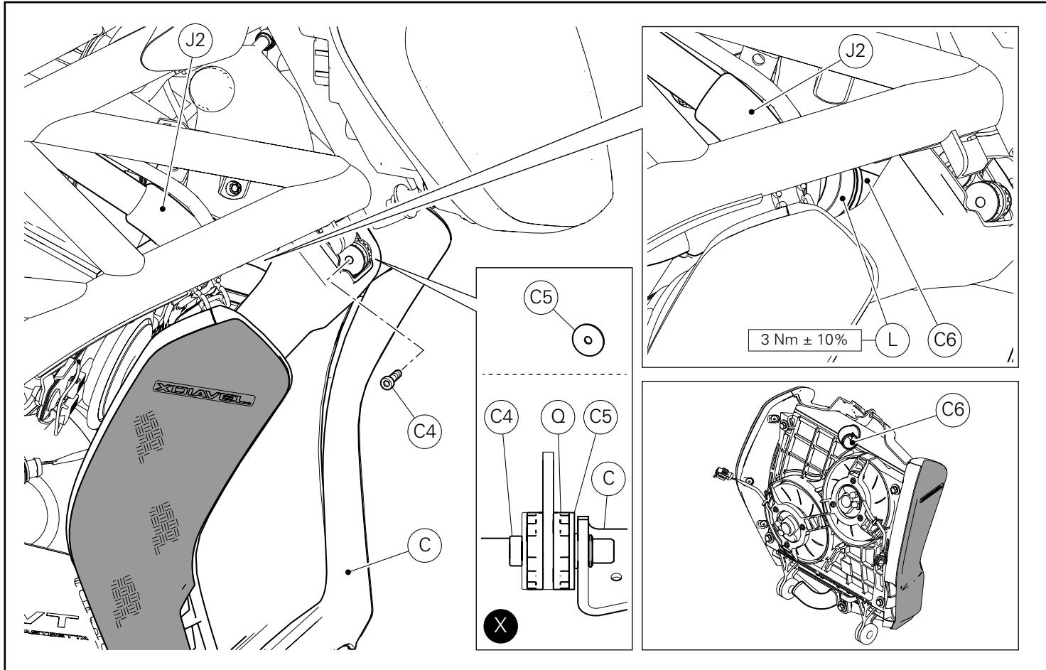
Inserire il manicotto radiatore-termostato (J2) nell'attacco superiore (C6).
